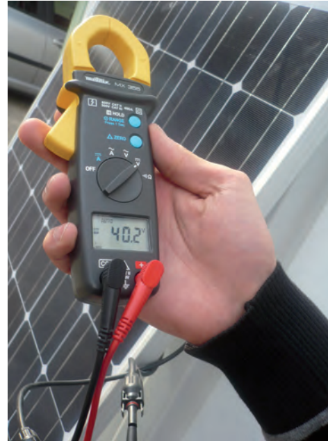
La tension mesurée doit être sensiblement égale à la tension indiquée sur la fiche technique du module.
